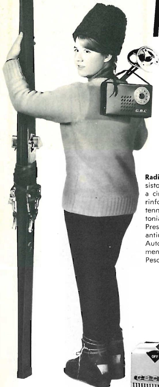
**Radoricevitore** supereterodina portatile a transistor per OM. - 6 transistor + 1 diodo. - Telaio a circuito stampato, altoparlante con magnete rinforzato ad alto rendimento acustico. - Antenna in ferroxcube incorporata. - Scala di sintonia demoltiplicata. - Presa antenna esterna. - Presa auricolare. - Mobile in materia plastica antiurto. - Alimentazione con due pile da 6 V. - Autonomia di circa 100 ore. - Impiegando l'alimentatore I/601 funziona con corrente luce. - Peso 840 g.
